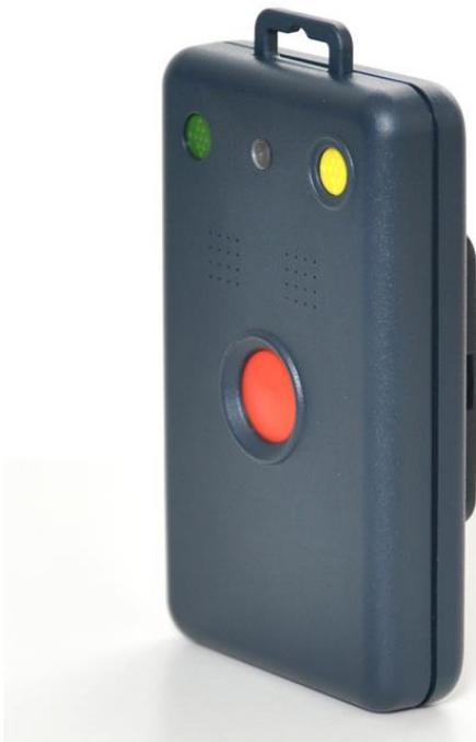
La localizzazione avviene tramite ripetitori collegati alla centrale (in ambiente chiusi il gps non funziona)
