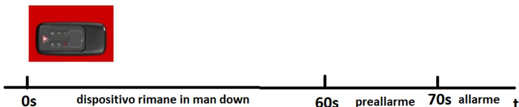
Se tra 0 secondi e 60 secondi il dispositivo dovesse tornare nella posizione di **NON allarme (posizione verticale)** la situazione di uomo a terra viene resettata.
