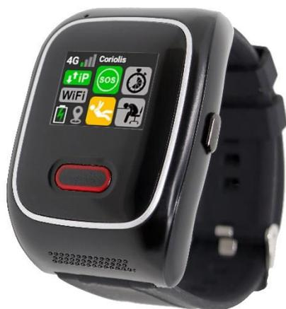
Il sistema Uomo a Terra **mydasoli WATCH** è un dispositivo leggero e compatto dotato di connettività GSM e GPRS; è in grado di determinare le coordinate del dispositivo stesso e di inviarle tramite rete 2G/3G/4G.
